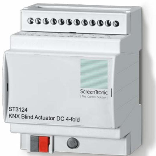
Der KNX Jalousieaktor DC wurde speziell für die Ansteuerung von Jalousien im Isolierglas entwickelt. Er ist für die Steuerung von 24V DC Motoren über eine 2-polige Anschlussleitung vorgesehen. Pro Ausgang können max. 4 Jalousien zusammengefasst werden, so dass mit dem Jalousieaktor max. 16 Jalousien in 4 Steuergruppen betrieben werden können.
