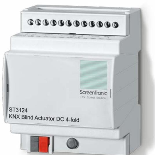
L'attuatore per tende KNX è stato sviluppato specificamente per la gestione di tende in vetrocamera. Il suo utilizzo è previsto per il controllo di motori a 24V DC con contatto a 2 fili. Ad ogni uscita possono essere collegate max. 4 tende. In totale, è pertanto possibile azionare tramite l'attuatore max. 16 tende suddivise in 4 gruppi.
