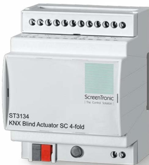
Der KNX Jalousieaktor wurde speziell für die Ansteuerung von Jalousien im Isolierglas entwickelt. Er ist für die Steuerung von 24V SC Motoren über eine 3-polige Anschlussleitung vorgesehen. Je Ausgang am Aktor wird eine Jalousie angeschlossen, die über 2 Adern mit Spannung versorgt wird und über die 3. Ader sehr präzise individuell gesteuert werden kann.
