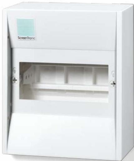
Aufputzgehäuse aus Kunststoff zum Einbau von Reiheneinbaugeräten. Das Gehäuse wird zur Aufputzmontage von Steuerungen und Netzteilen verwendet. Dabei können Geräte mit insgesamt bis zu 6 Teilungseinheiten untergebracht werden.
