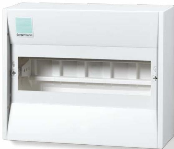
Aufputzgehäuse aus Kunststoff zum Einbau von Reiheneinbaugeräten. Das Gehäuse wird zur Aufputzmontage von Steuerungen und Netzteilen verwendet. Dabei können Geräte mit insgesamt bis zu 10 Teilungseinheiten untergebracht werden.
